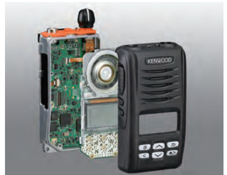
落下・衝撃に強い (二重構造パネル)
