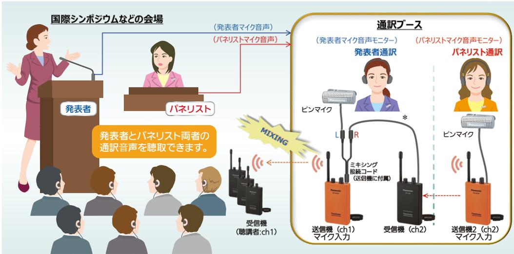
ミキシング送信機の近くに話者がいる場合、例えば通訳ブースから送信するようなケースでは、ミキシングパターン1の送信機1と受信機1を直接付属マイクの入力に置き換えることが可能です。3台のパナガイドでミキシング送信を行えます。
