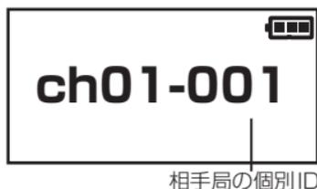
「通報ボタン」を押して「相手局の個別ID」を点滅させてから「▲」・「▼」キーで相手局を選択します。このとき「MODE」キーを押すと表示点滅の桁が移動します。もう一度「通報ボタン」を押して点滅を止めたら選択が決定します。
