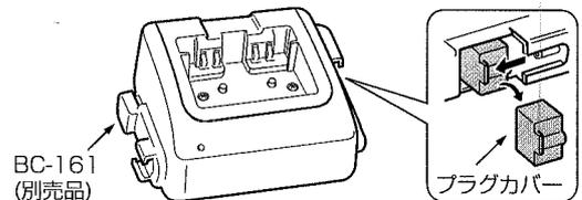
②右側面にあるDCプラグと、もう1台のBC-161(左側面)にあるDCジャックを「カチッ」と音がするまで差し込みます。
