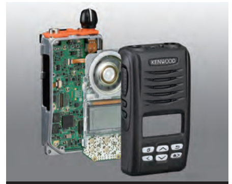
落下・衝撃に強い (二重構造パネル)
