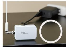
推奨の設置方法：直接コンセントに挿さないで、○イメージのように電源タップでコンセントからケーブルを伸ばし、ロッカーや棚等の上に固定する。
