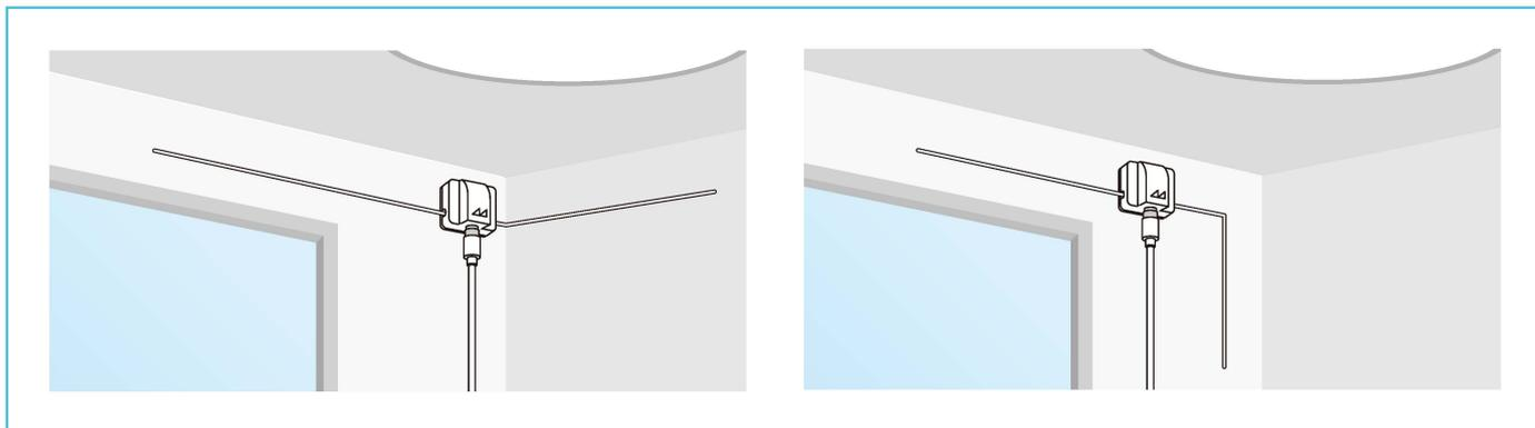
設置場所に応じて様々な角度での取り付けが可能(※最適な受信レベルを確保出来るように位置調整してください)
