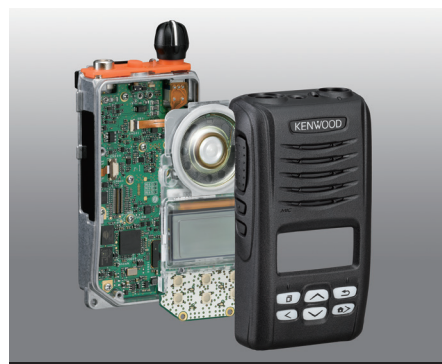
落下・衝撃に強い (二重構造パネル)
