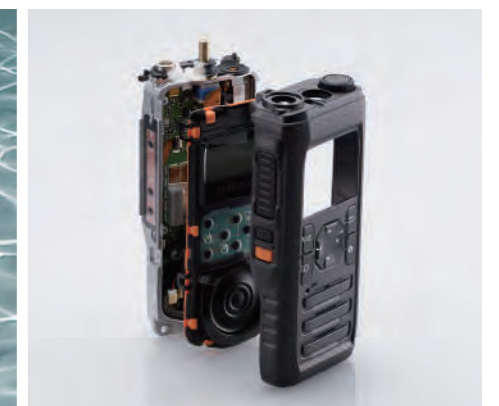
防塵/防水/衝撃/歪に強い2重構造
