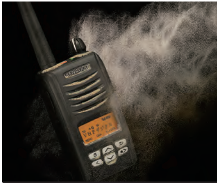
粉塵の侵入を許さない (IP6_防塵形)
