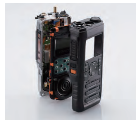
防塵/防水/衝撃/歪に強い2重構造
