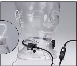
咽喉イヤホンマイク EME-62A ¥50,380 (¥45,800) *声を出す時に動く咽喉部の振動を音に変換するため、通常のマイクが騒音で使えない環境でも通話ができます。 *マイクの性質上、わずかに音質は劣ります。
