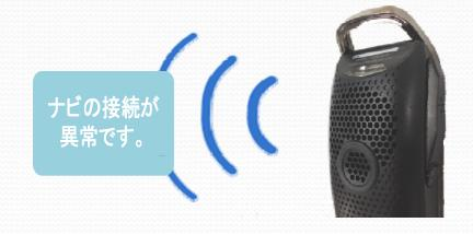
無線機本体とナビは常に通信しています。ケーブルが外れたことを検知して音声アナウンスが流れます。ナビ接続の設定をONにした状態で、ナビを接続しないと音声アナウンスが流れてしまいます。ナビを接続しない無線機はナビ接続の設定をOFFにしてください。
