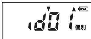
MCA 個別呼出し運用の設定は、モードキー
