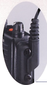
水分がしみこまない ネジ止め式アクセサリポート
