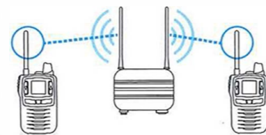
CL45 中継器を経由して通話エリアを拡大
