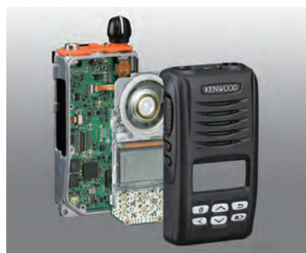
落下・衝撃に強い（二重構造パネル）
