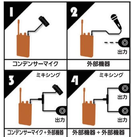
\* マイク / 外部入力切替スイッチと付属のミキシング接続コードを併用することで実現。外部機器入力はダイナミックマイクやパナガイド受信機のイヤホン出力、一般のオーディオ機器のヘッドホン出力やライン出力などを入力できます。また、業務用のミキシングアンプなどからの信号も入力できます。
