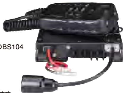
●AC100Vから電源を取るには安定化電源が別途必要です。専用のオプション・アクセサリ、DM-S104をお勧めします。
