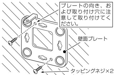
上の図の穴以外では取り付けしないでください。壁面プレートがはずれ、落下の原因になります。
