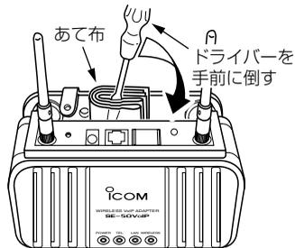
[壁面プレート]を使用しないときも同じようにあて布をしたドライバーで壁面からはずします。この時壁面を傷つけないようご注意ください。
