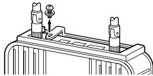
②弊社製無線LAN機器と[壁面プレート]の上部のすき間に、あて布をしたドライバーを入れ、手前に倒すようにしてはずしてください。
