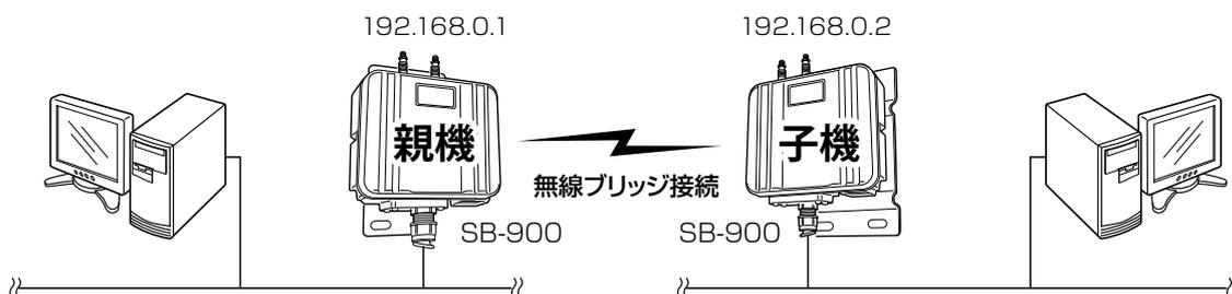
◎子機側がスキャンして、SSIDと暗号化が一致した親機と接続します。
