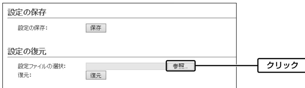
3 「アップロードするファイルの選択」画面(別画面)から、設定ファイル(拡張子:sav)を指定して、〈開く(O)〉をクリックします。
