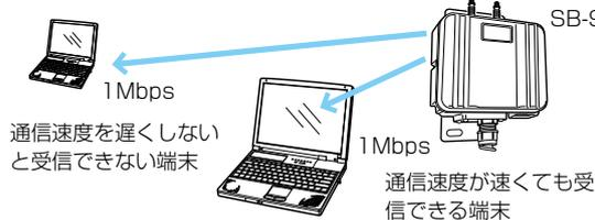
エリアや端末の受信状況により、マルチキャストパケット伝送時の通信速度を選択すると、動画配信にも対応できるようになります。
