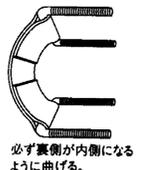
ベルト両端のUボルトに基台を取り付け、スプリングワッシャー・ナットを4カ所に入れます。
