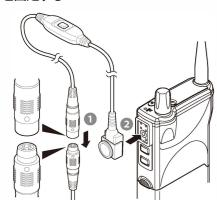
付属のヘルメットクリップをヘルメットに取付ける \*作業時の安全のためヘルメットクリップのバネは、きつめに設 定されていますので、取付けの際は注意してください。
