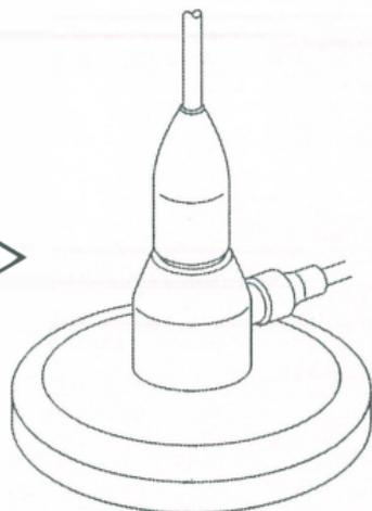
基台ねじ部にばね座金を取付けてエレメントプラグをねじ込んでください。
