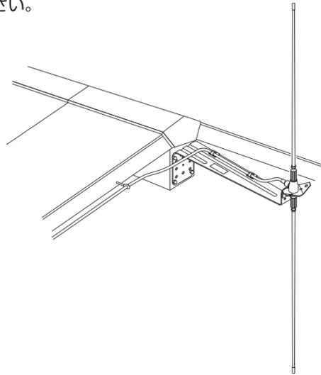
※アンテナは上図の様にエレメントを縦向きにして設置して、横向きには設置しないでください。
