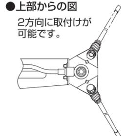
※角度取付金具へのエレメントの取付けは下側のみとなります。上側のエレメントは必ず給電部に取付けてください。
