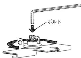
① KTHマウント金具上面についているボルトを緩めて横に回します。
