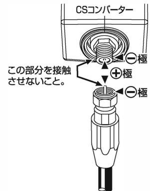
※中心コンタクト(+極)をCSコンバーター出力端子外側の-極に接触させるとショートします。
