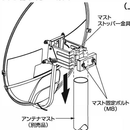
先端取付の場合は、マスト固定ボルト(M8)2本をゆるめ、図のようにアンテナマストの上部から挿入し、アンテナマストがマストストッパー金具に当たる位置にマスト固定ボルト(M8)で仮止めします。アンテナ調整後、指定のトルクで締め付けてください。
