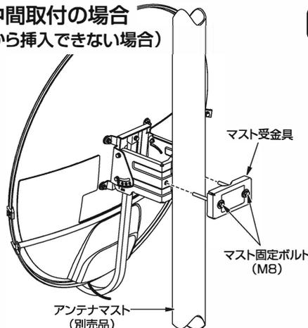
アンテナマストの中間に取り付ける場合(上から挿入できない状態)は、マストストッパー金具の向きを90°程度かえます。マスト受金具をいったん取りはずし、任意の位置で再度マスト受金具を取り付けてマスト固定ボルト(M8)で仮止めしてください。アンテナ調整後、指定のトルクで締め付けてください。
