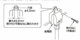
③エレメントを配線します。エレメントの根本・中 央·先端に、それぞれエレメントクリップを配置 させ、取付ねじ(市販品)を使用して取り付け てください。
