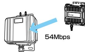
※出荷時、マルチキャスト送信レートは、無線LAN規格の最低レートに設定されています。
