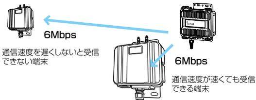
エリアや端末の受信状況により、マルチキャストパケット伝送時の通信速度を選択すると、動画配信にも対応できるようになります。
