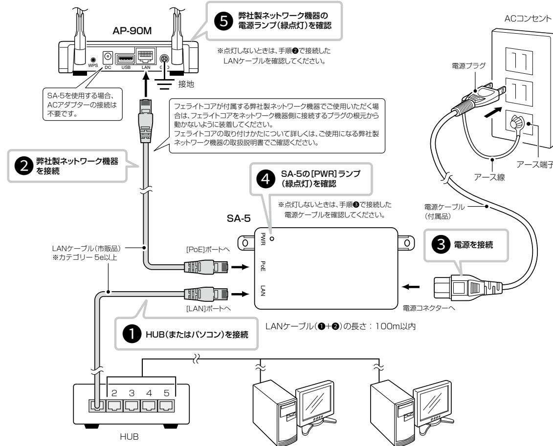
① 本製品の[LAN]ポートとHUB(HUBを使用しない場合は、パソコン)★をLANケーブルで接続します。
