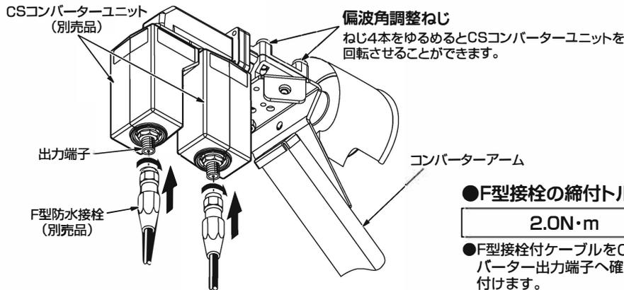
●出力端子に接続した接栓は次の要領でテーピングしてください。(レベルメーターの接続調整後に実施)
