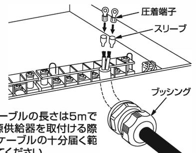
※ヒーターケーブルの長さは5mですので、電源供給器を取付ける際はヒーターケーブルの十分届く範囲に設置してください。
