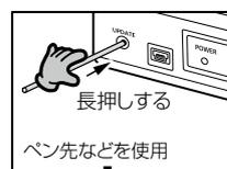
2 [MSG]ランプが⦿点滅(緑)したことを確認して、<UPDATE>ボタンから手をはなします。ファームウェアのダウンロードを開始し、更新後は自動的に再起動します。
