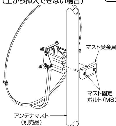
アンテナマストの中間に取付ける場合(上から挿入できない状態)は、マストストッパー金具の向きを90°程度かえます。マスト受金具をいったん取りはずし、任意の位置で再度マスト受金具を取付けてマスト固定ボルト(M8)で仮止めしてください。アンテナ調整後、指定のトルクで締付けてください。
