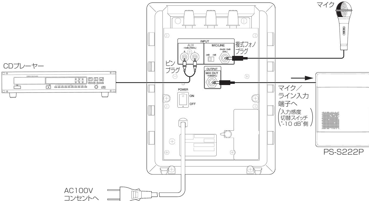
有線マイクをマイク／ライン入力端子に接続します。CDプレーヤーやコンピューターの音声出力をAUX入力端子に接続します。AC電源コードをAC100Vコンセントにつなぎます。接続されている機器の電源を入れます。最後に本機の電源を入れます。
