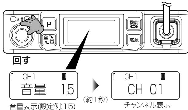
詳細設定モードで、[P] (プログラム)キーの動作を「P長 モニタ」(☞P7-6)に設定することで、[P] (プログラム)キーを押しているあいだ、[送・受]ランプが緑色に点灯します。 「ザー」という音が出ますので、この音を聞いて調整できます。(☞P6-1)
