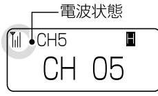
通話相手以外の電波(同じ通話チャンネルで誰かが通話中)を受信しているときも、[送・受]ランプが緑色に点灯し、電波の受信状態を表示します。
