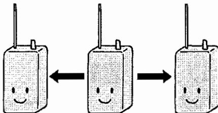
最も基本的な交互通話（単信）モードです。工場出荷状態で電源を入れると、このモードになります。送信時に[PTT]キーを押して通話します。周波数構成が同じであれば、他の特定小電力トランシーバーとも通信できます。
