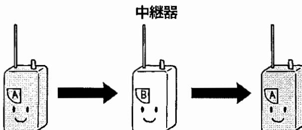
半複信方式の中継器にアクセスできるモードです。中継器を使用することによって、直接では電波が届かない相手と通信することができます。周波数構成が同じであれば、他の中継器対応タイプの特定小電力トランシーバーとも中継器を介して通信できます。
