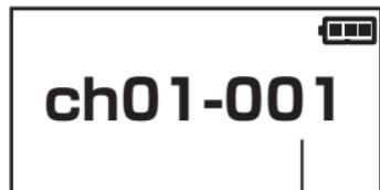
「通報ボタン」を押して「相手局の個別ID」を点滅させてから「▲」・「▼」キーで相手局を選択します。このとき「MODE」キーを押すと表示点滅の桁が移動します。もう一度「通報ボタン」を押して点滅を止めたら選択が決定します。
