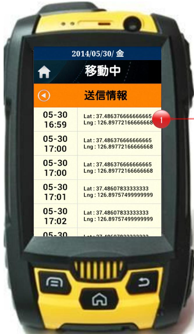
① 送信されたGPSの緯度、経度情報リストを表示します。(最大10件)
