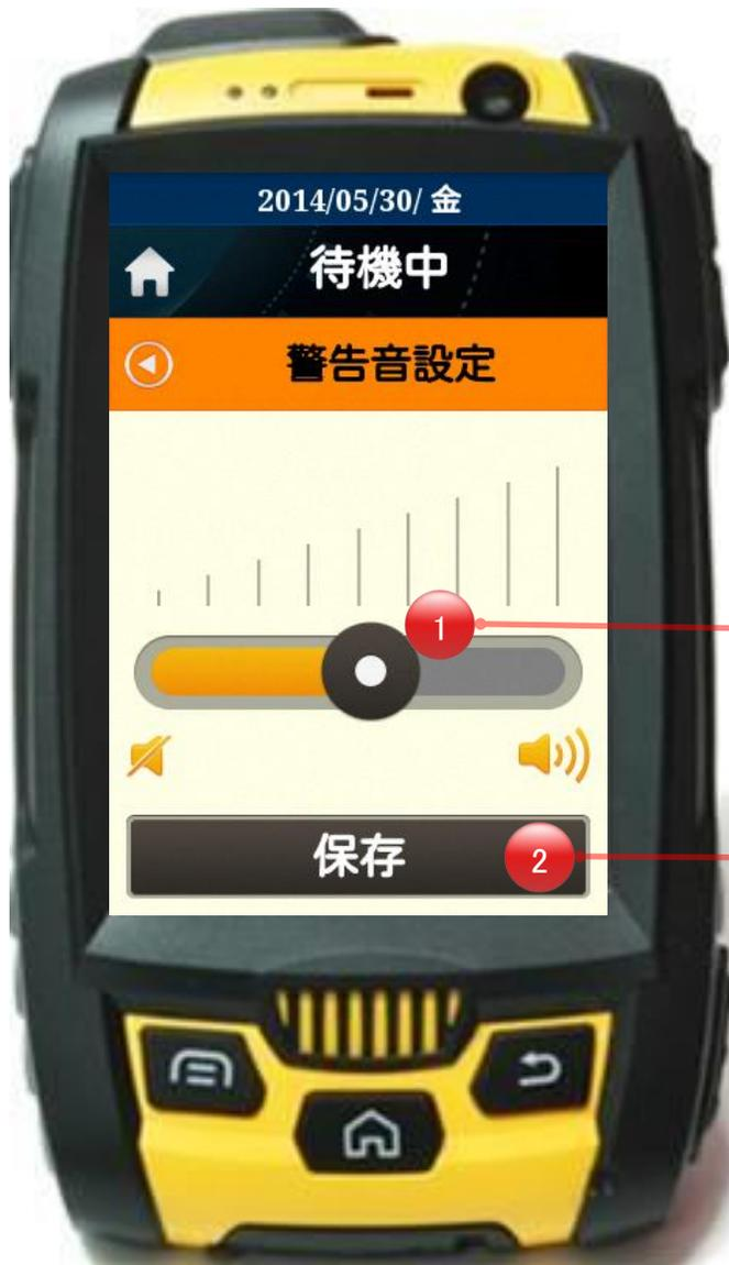
① ボタンを左右に移動させると警告音の音量を変更できます。
