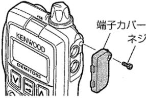
プラスドライバー( # 1 )でネジを左方向に回して取り外し、端子カバーを外します。
