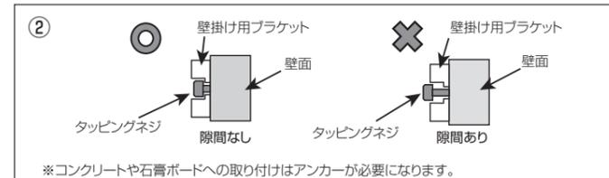
③ 壁掛け用ブラケットに本機を取り付けます。ブラケットの4か所のツメと本機底面部の固定ツメを合わせます。
