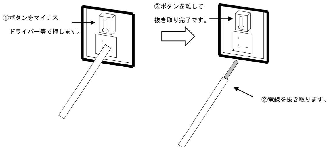
電線接続手順(抜き取るとき)
