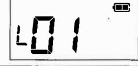
**メモ** キーを押し続けると連続してチャンネルが切り替わります。CH[▲/▼]キーを同時に押しと「ザー」というノイズが聞こえ音量の目安となります。適切な音量に調整してください。
