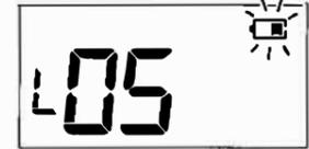
**メモ** 「電源が入らない」「オンオフを繰り返す」「ディスプレイの表示が消える」などの症状が出た場合も電池の消耗が考えられるため、バッテリーを充電、もしくは新しい電池と交換してください。
