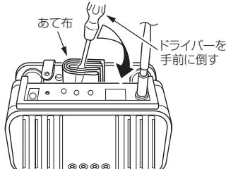
[壁面プレート]を使用しないときも同じようにあて布をしたドライバーで壁面からはずします。
