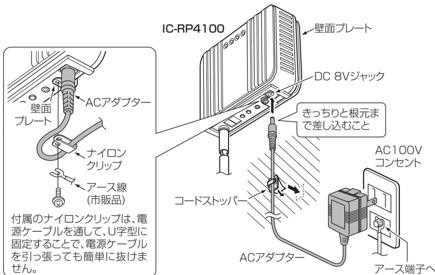
付属のナイロンクリップは、電源ケーブルを通して、U字型に固定することで、電源ケーブルを引っ張っても簡単に抜けません。
