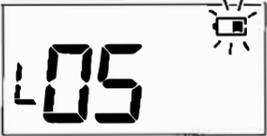
**メモ** 「電源が入らない」「オンオフを繰り返す」「ディスプレイの表示が消える」などの症状が出た場合も電池の消耗が考えられるため、バッテリーを充電、もしくは新しい電池と交換してください。
