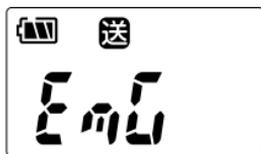
エマージェンシートーンが鳴り、現在のチャンネルでエマージェンシー動作を開始します。エマージェンシー送信中は自動でマイク感度を上げて送信音声を大きくします。エマージェンシー動作中は、【電源 / 音量】、【PTT】以外のキーは動作しません。
