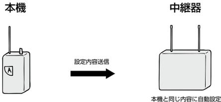
①本機の通話方式を中継器機通話に設定します。あらかじめチャンネルとグループ番号を設定します。誤判定を防ぐために近距離で作業してください。
