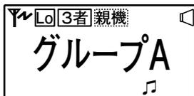
②子機1（2人目）は親機の音声を受信した後に「PTT」スイッチをオンにして送信状態にします。その後マイクに向かって話します。通信成立後「子機」と表示されます。
