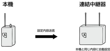
①本機の通話方式を連結子機通話に設定します。あらかじめチャンネルと個体番号を設定します。誤判定を防ぐために近距離で作業してください。
