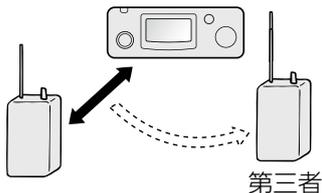
①待受状態で1人目が「PTT」スイッチをオンにして送信状態にしてマイクに向かって話します。チャンネルの後ろのAがBに変わり、ランプが赤く点灯します。
