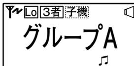
③子機2（3人目）は親機、子機1の音声を受信した後に「PTT」スイッチをオンにして送信状態にします。通信成立後「子機」と表示されます。それぞれで通話できるか確認します。
