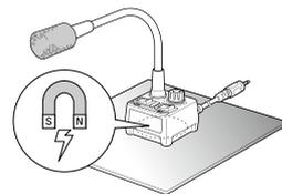
**注意** 底面には、強力な磁石を使用しています。設置する場合は平らな金属面に設置し、しっかりと固定できていることを確認してください。取付け後は試運転して落下、転倒が無いことをよくご確認のうえお使いください。
