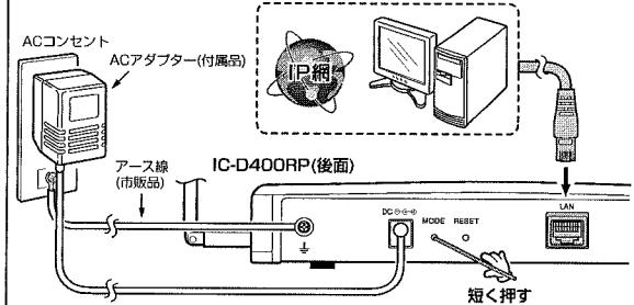
\*SA-3(☞4-3章)と本製品が接続されている場合、IP網がSA-3の[To HUB]ポートと接続されない状態では、〈MODE〉ボタンを短く押すと運用チャンネルが切り替わります。
