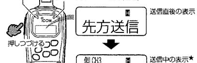
★個別呼び出し機能(☞P12)が設定されていない場合は、「先方送信」表示(約2秒)後、通話チャンネル(CH)番号を表示します。
