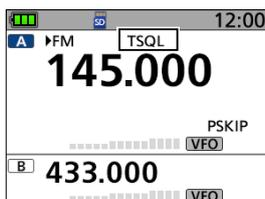
※コードスケルチ使用時、コード検出時の位相を反転させる場合は、右キーでカーソルを位相表示にして、[DIAL]を回すとノーマルとリバースを切り替えられます。
