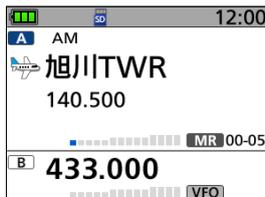
3. [V/MHz]を押して、VFOモードにする
