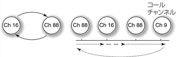
→ チャンネル16で信号を受信した場合、その信号がなくなるまでチャンネル16でデュアルワッチ/トライワッチは、一時停止します。
