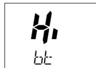
装着したバッテリーバックの電圧が規定範囲外
